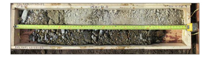
**Photo 30:** Borehole GT18-09; Depth 15.0 - 21.0 m
